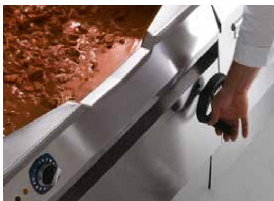
Sollevamento manuale vasca con controllo preciso
